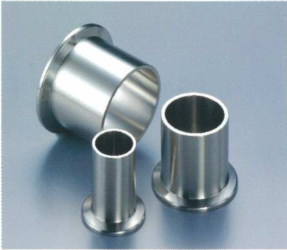
■材質：SUS304、SUS316L ■フランジ材質はSUS304が標準です。SUS316Lをご注文の際は、型番末尾に「-6L」とご指定ください。
